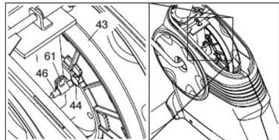
Поверните шкив (43), пока магнит шкива (44) не совместится с герконом (46). Немного сдвиньте переключатель геркона в сторону магнита шкива или от него. Затем затяните винт M4 x 16 (61).
