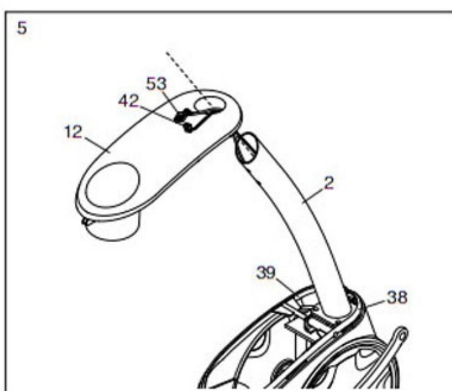
6. Расположите кронштейн пульта управления (11), как показано на рисунке. Протяните основной кабель (53) и кабель пульсометра (42) через кронштейн пульта управления.
