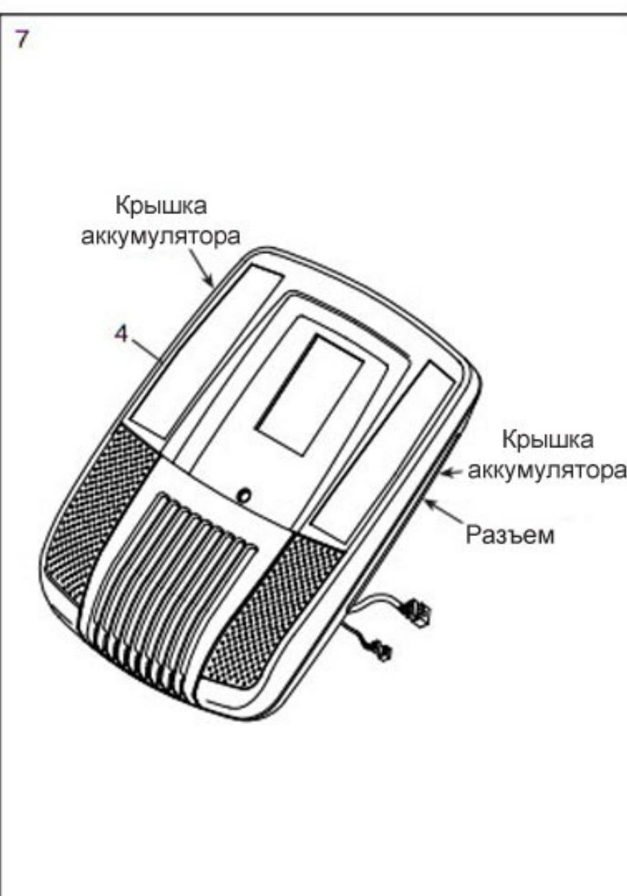
8. В то время как второй человек держит пульт управления (4) вблизи кронштейна пульта (11), соедините провода на пульте управления с главным проводом (53) и проводом пульсометра (42).
